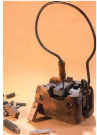
Handgießinstrument wahrscheinlich noch aus dem 17. Jahrhundert, mit einem Stempel, drei Matrizen, einer Rohtype und einer Anzahl druckfertiger Typen.
